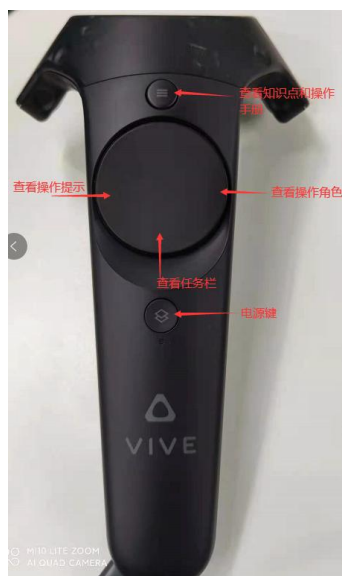
图-6 左侧操作手柄的功能示意图
