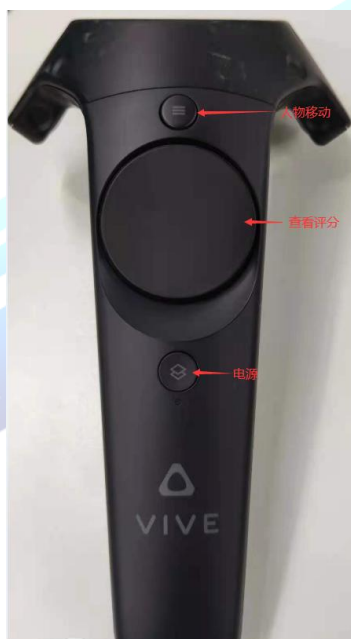
图-7 右侧操作手柄功能示意图
